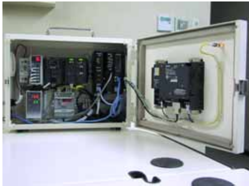
デモ機 (PLC + タッチパネル + データ収集装置)
